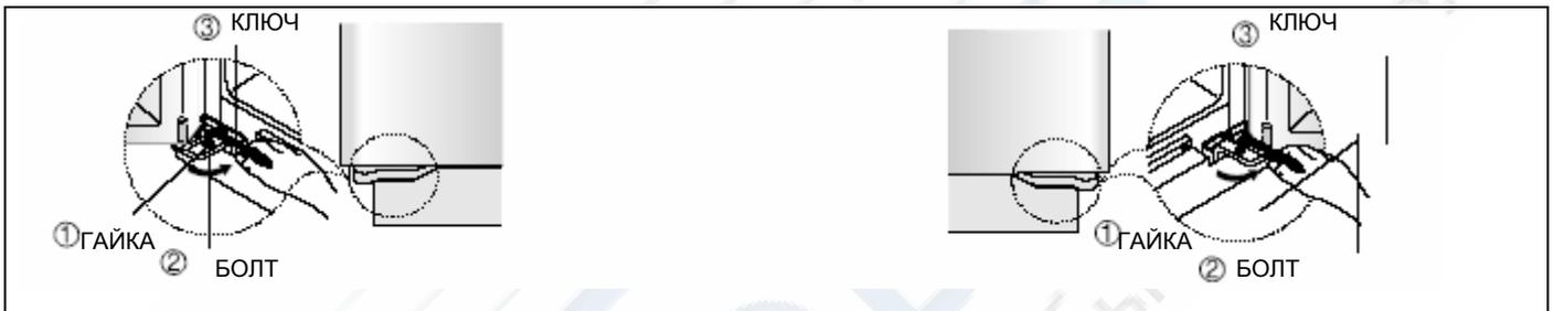
2) Отрегулируйте разницу по высоте между дверцами, поворачивая болт (②) по часовой стрелке (↻) или против часовой стрелки (↻).
